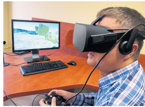
Stanowisko szkoleniowe składa się z komputera, monitora, wyświetlacza nagłownego HMD-Oculus i stworzonej w KOMAG-u aplikacji.
